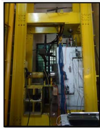
Gambar 8. Setup Percobaan Sambungan Kunci Geser
