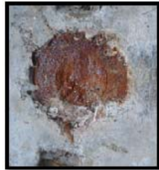
Gambar 16. Kondisi Male Shear Key setelah Percobaan Dilakukan
