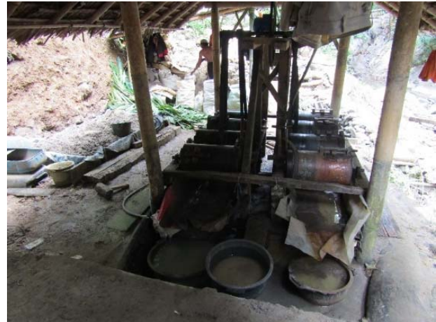
Gambar 8. Proses Amalgasi dengan Bantuan Motor Listrik
