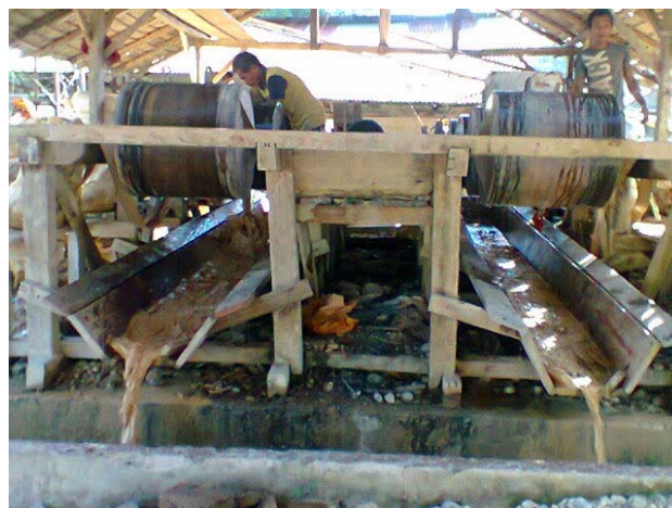
Gambar 11 Alat Kasbok yang dilapisi ijuk untuk Menangkap Butiran Emas
